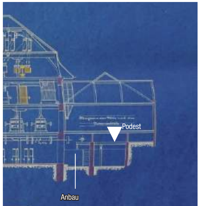
Projektplan automatische Mühle, Ausschnitt mit Querschnitt durch Kleiema-gazin und durch das Podest , 1912 (Familienarchiv Reinhard )
